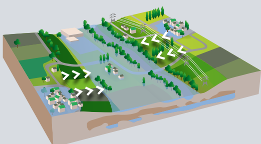
Inondation par ruissellement pluvial
